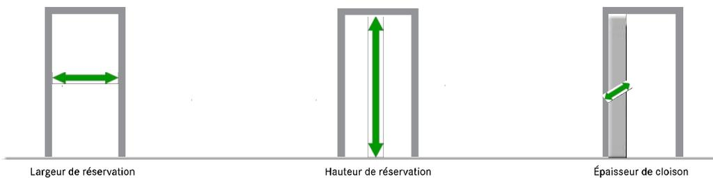
Mesurer en 3 points la largeur, la hauteur et l'épaisseur, prendre en compte la faïence murale et vérifier ci-dessous les dimensions pour s'assurer l'installation des portes standard en fin de chantier.
